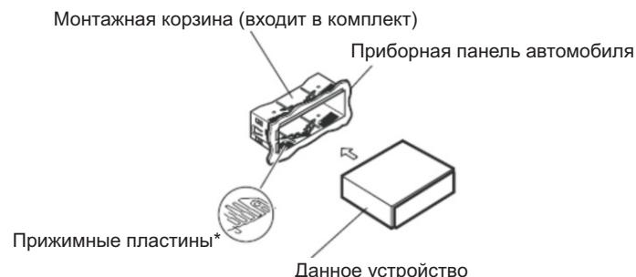
\* Если установленный монтажный кожух выпадает из приборной панели, для устранения слегка согните прижимные пластины.
