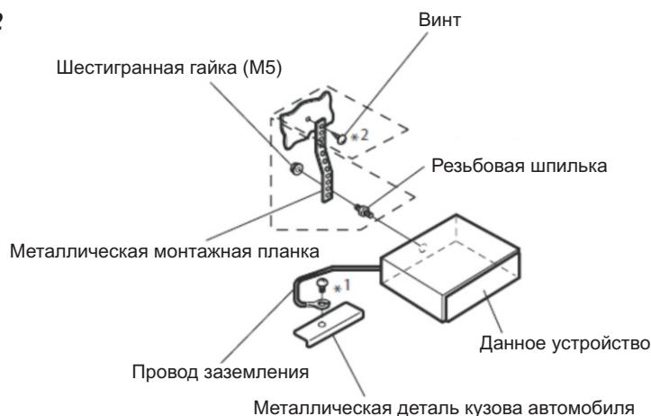
Для закрепления головного устройства воспользуйтесь металлической монтажной планкой (в комплект не входит). Соедините провод заземления устройства с чистой металлической деталью кузова автомобиля и закрепите его штатным винтом (\*1), уже имеющимся на кузове автомобиля.
